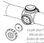
La pile pour l'illumination du réticule est située dans le bouton de contrôle d'intensité et peut être changée sans outil.
