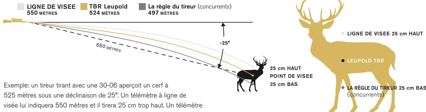
Exemple: un tireur tirant avec une 30-06 aperçoit un cerf à 525 mètres sous une déclinaison de 25°. Un télémètre à ligne de visée lui indiquera 550 mètres et il tirera 25 cm trop haut. Un télémètre concurrent à inclinomètre utilisant la « règle du tireur » lui indiquera 497 mètres et il tirera 25 cm trop bas. Le télémètre RX lui indiquera la vraie distance balistique de 524 mètres pour un tir au but.
