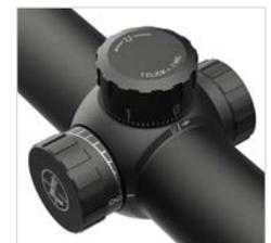
Ausgewählte Mark 3 HD-Zielfernrohre sind mit P5-Verstelltürmen für fühl- und hörbare Klicks ausgestattet, die eine präzise 0,1 MIL (1 cm auf 100 m) Höhen- und Seitenverstellung bieten.
